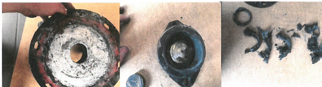
Nedslidte dele til bundstyr for askesnegl fra service 2017
